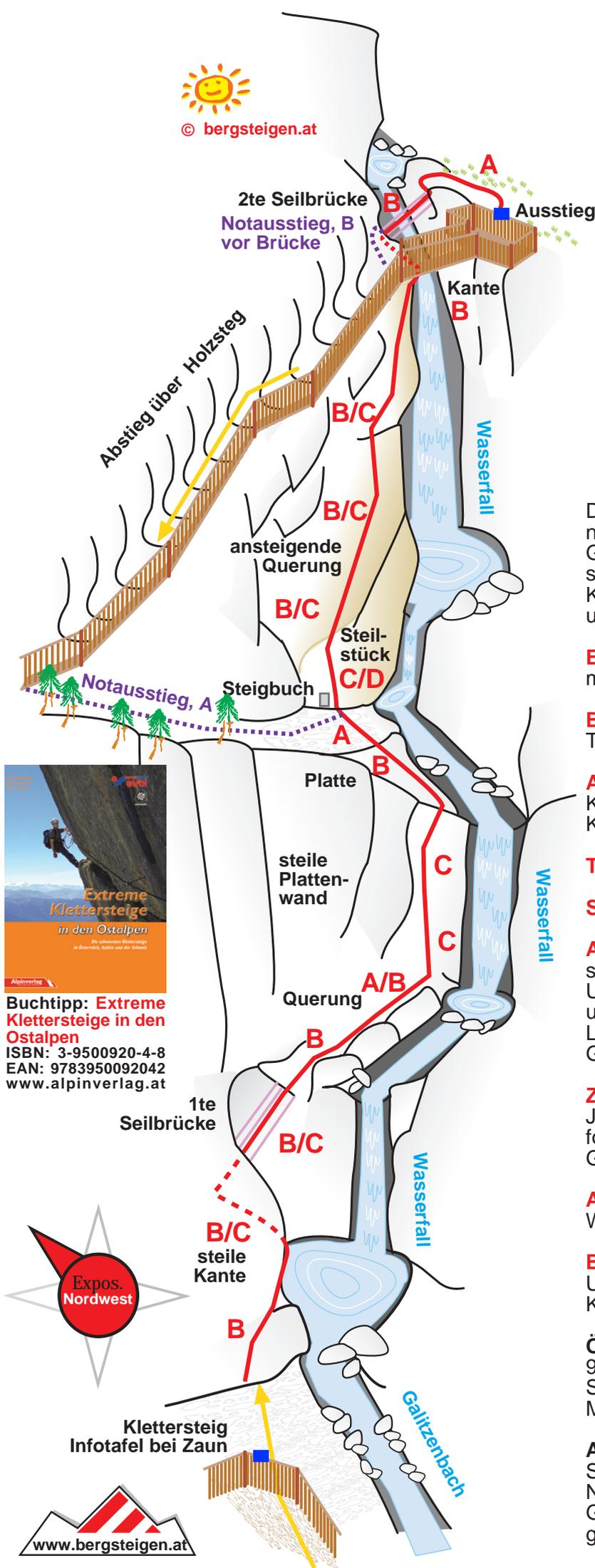
Der im Sommer 2006 eröffnete Klettersteig verläuft neben dem beliebten Wasserschaupfad durch die Galitzenklamm. Die beiden Nepalbrücken und die ständige Nähe zum Wasser sind die Höhepunkte des Klettersteigs. Insgesamt wurden 270 Meter Stahlseil und 250 Anker verbaut.
