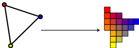
Rysunek 2.3 Diagram obrazujący sposób rasteryzacji trójkąta o przypisanych kolorach wierzchołków.
